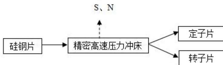
图 2-2 生产工艺流程及产污环节图
