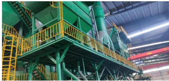
图 3-1 砂处理线废气处理设备
