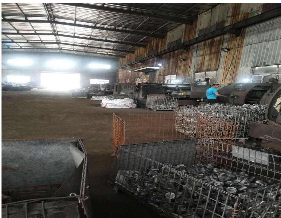
④机械加工：经抛丸处理的铸件利用数控车床、小钻床等进行机械加工。
