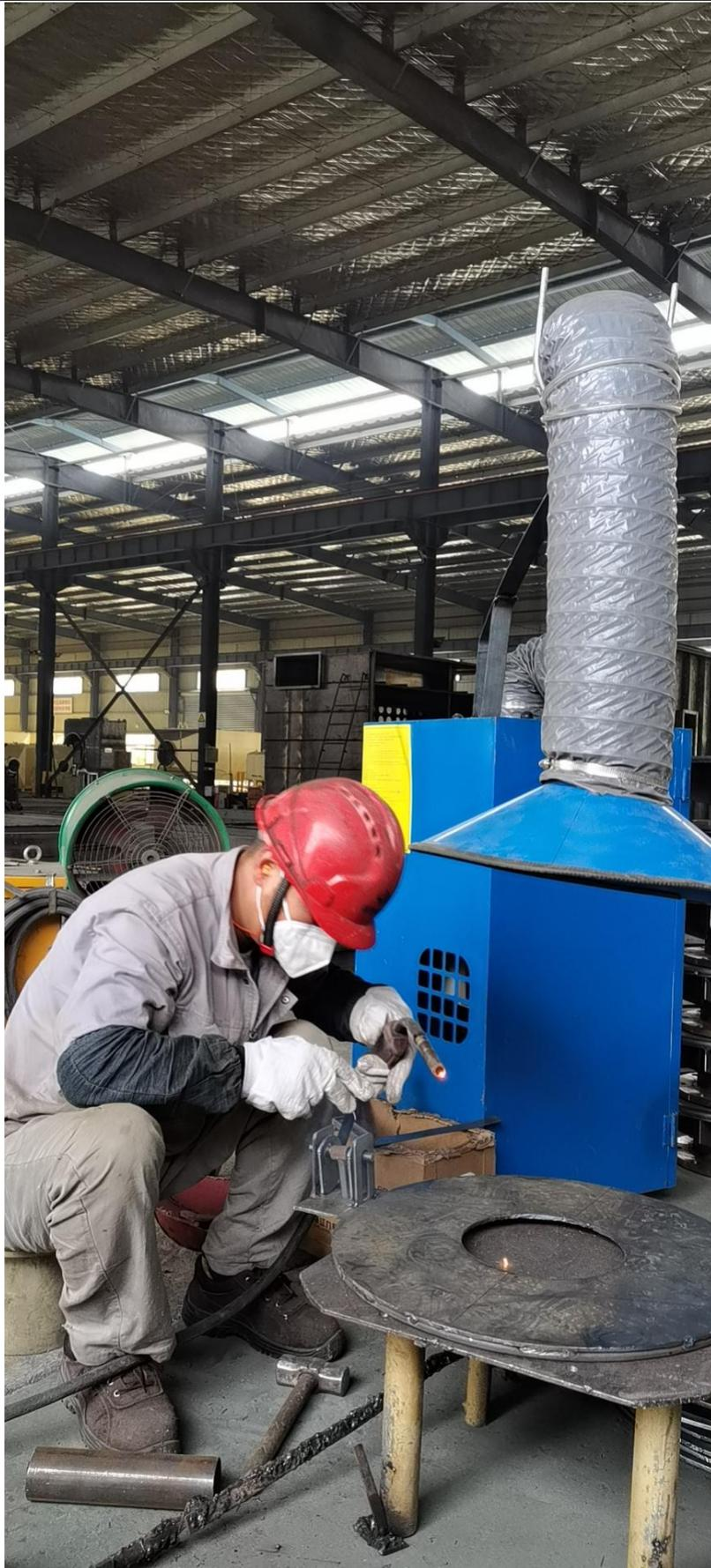
图 6-3 移动式焊烟净化器
