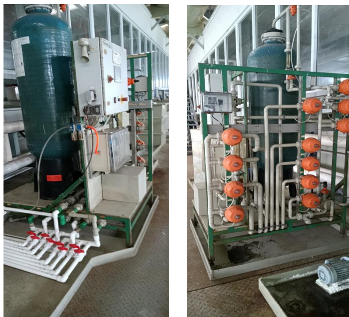
图 5-3 移动式钝化液再生设备
