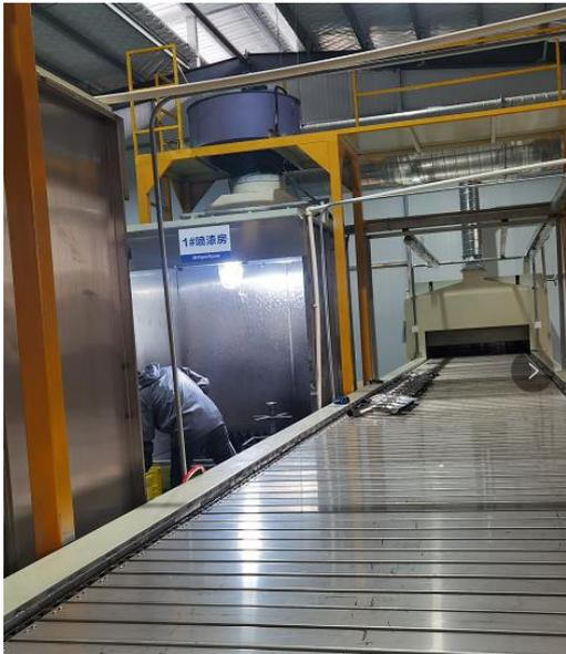
图 3：手动喷漆操作台及烘道
