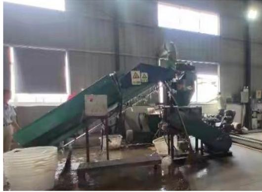
图 5-5：挤出拉丝机
