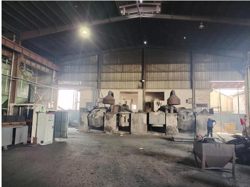
图 6-2 中频电炉
