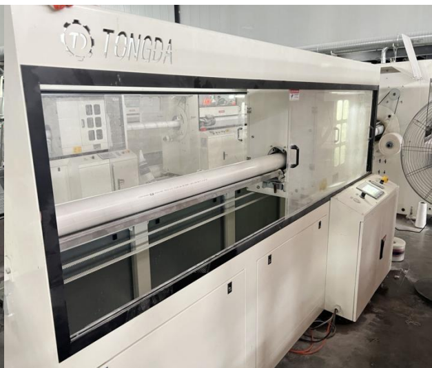
图 5-6 定长切割工序图
