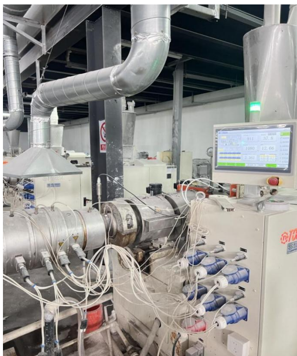
图 5-3 塑化、挤出工序图
