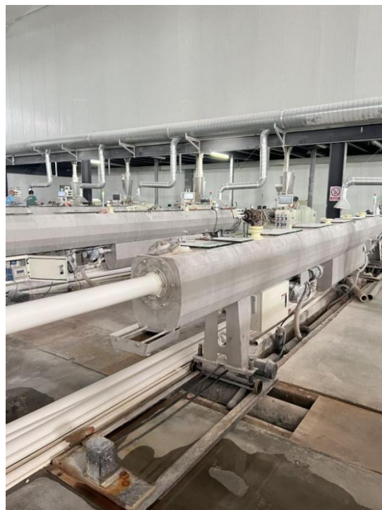
图 5-4 真空冷却定型工序图
