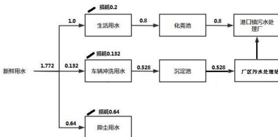
图 4-1 项目水平衡图 单位： $\text{m}^3/\text{d}$
