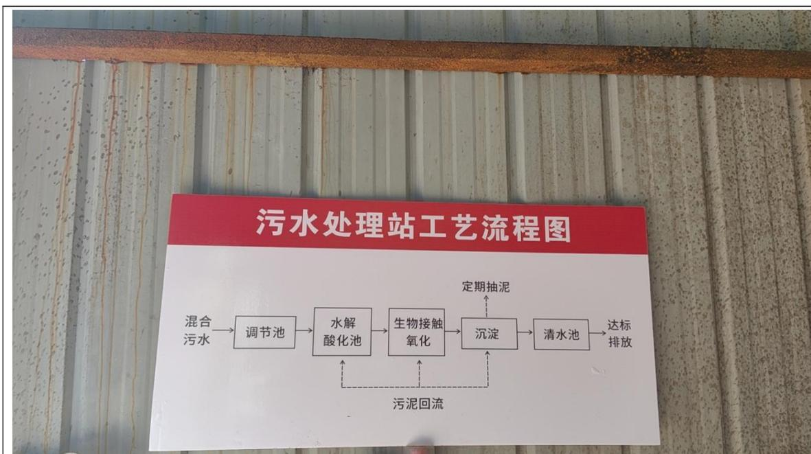
图 6-1 污水处理站及工艺流程图
