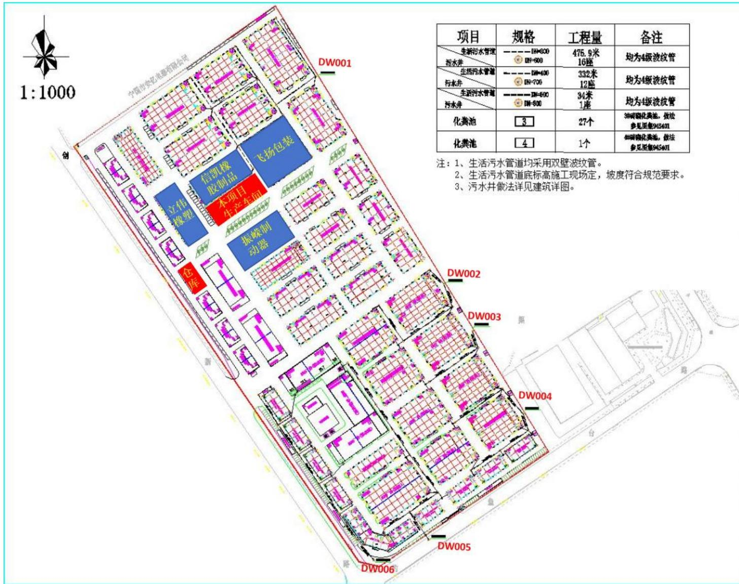
图 5-5 园区雨污管网图
