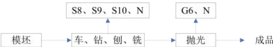
图 3-6 橡胶制品生产工艺流程及产污节点图
