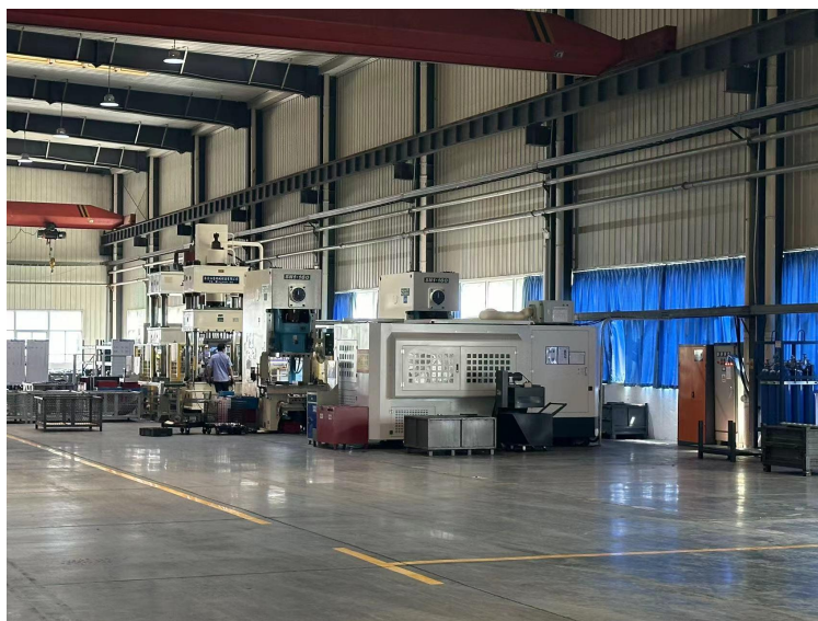
图5-10 自动冲压生产线
