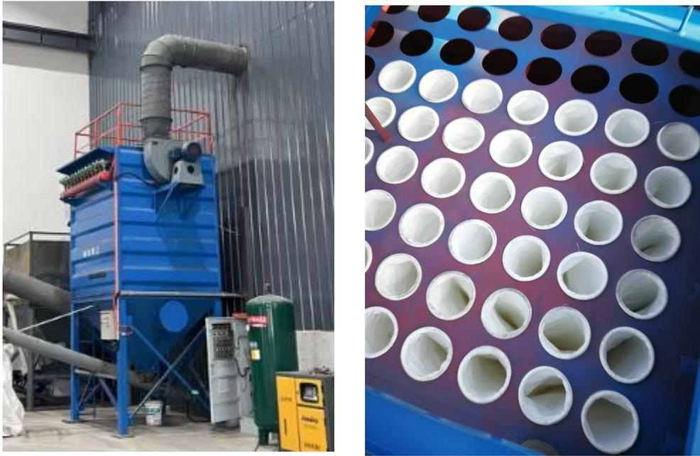
图 7-1 布袋除尘器及内部照片
