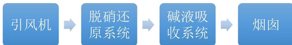
干法脱硫又叫做干法烟气脱硫，它的优点是工艺过程简单，无污水、污酸处理问题，能耗低，特别是净化后烟气温度较高，有利于烟囱排气扩散，不会产生“白烟”现象，净化后的烟气不需要二次加热，腐蚀性小。
